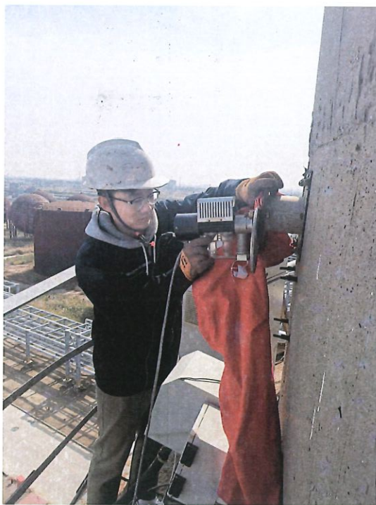
图 3 燃气锅炉排气筒采样照片
